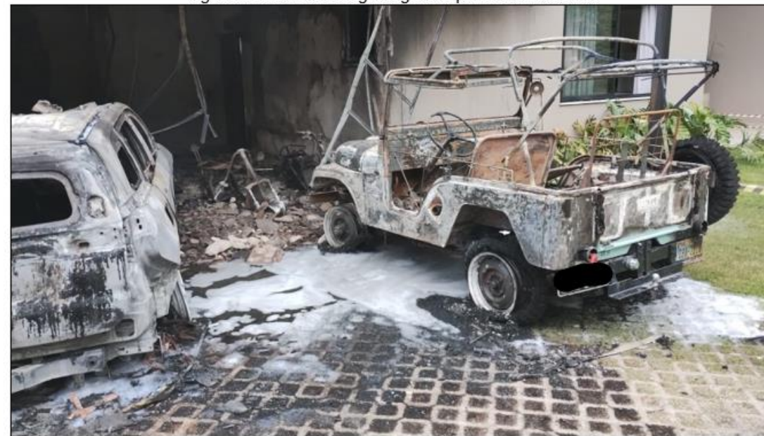
Figura 2 – Danos do fogo originado por veículo elétrico
