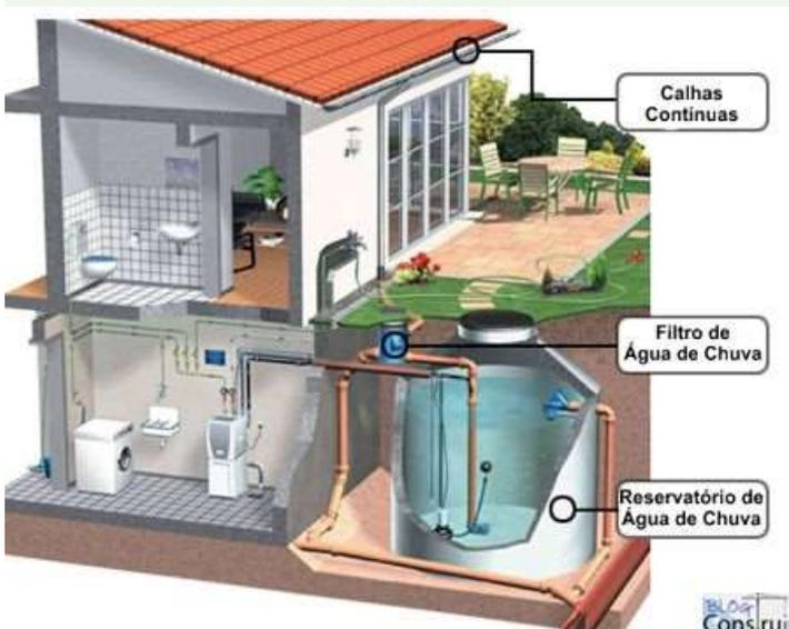
Captação, armazenamento e tratamento de águas pluviais para reutilização na irrigação, limpeza, refrigeração, sistema de combate a incêndio e demais usos permitidos para água não potável.
