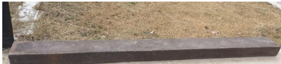
Durmiente de plástico reciclado fabricado experimentalmente
