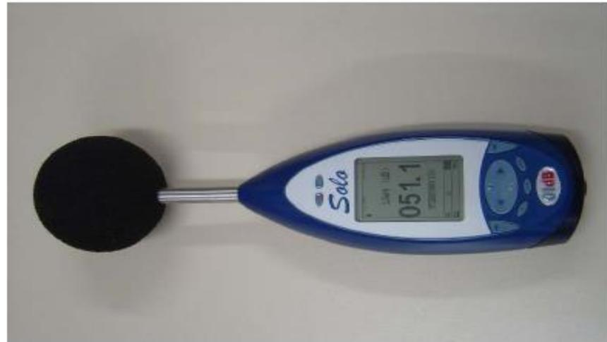
Aparelho medidor de nível sonoro Classe 1, modelo Blue Solo (01dB Metravib), nº de série 60677.
