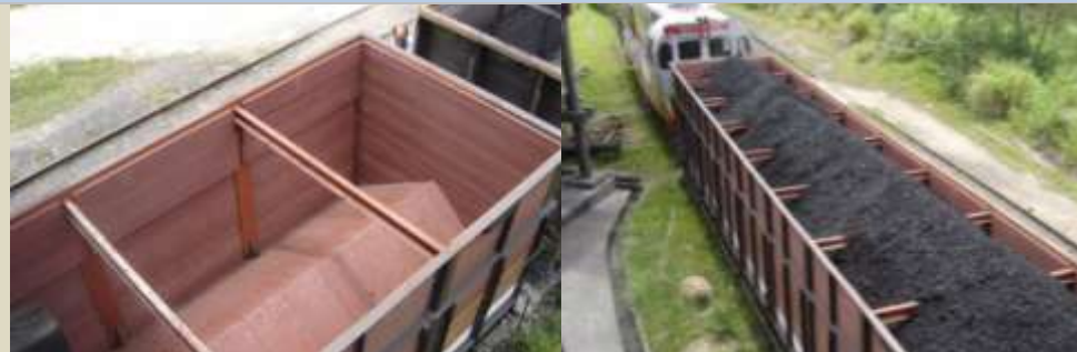
Substituição de madeira por plástico reciclado em vagão - FTC
