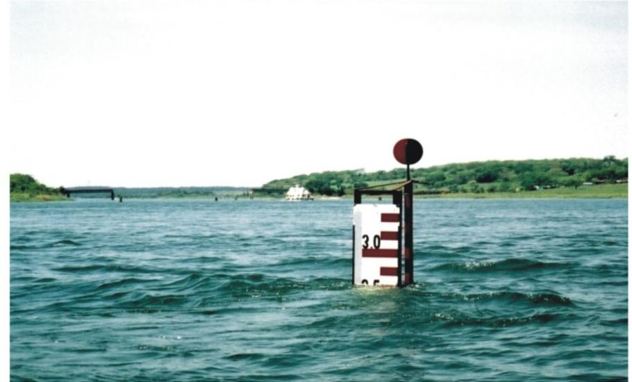
Régua de medição do nível d'água
